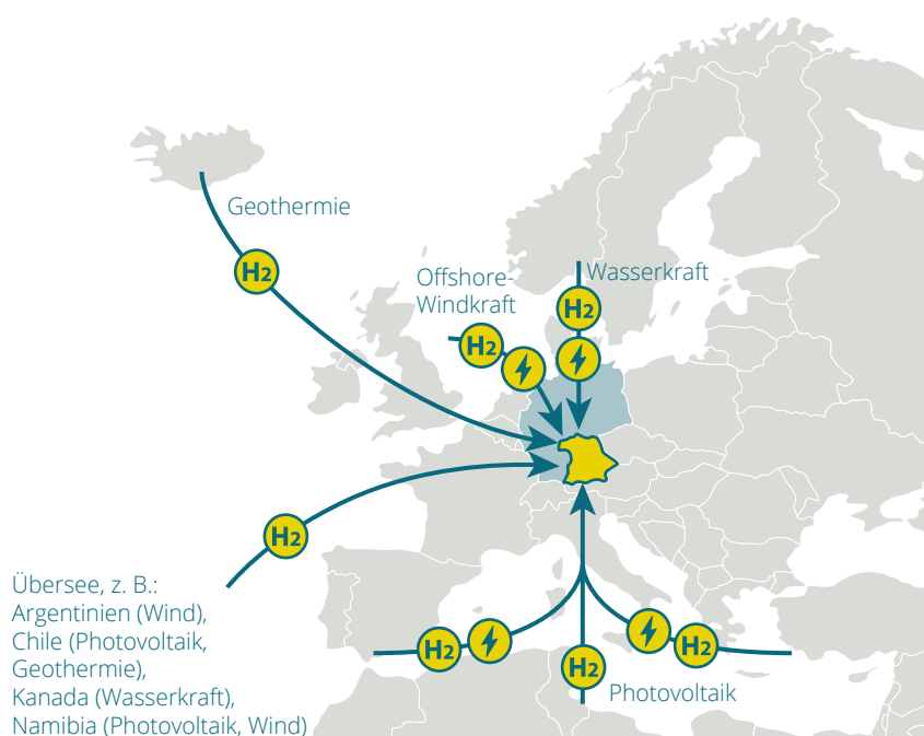
Abbildung 5: Wasserstoff macht Erneuerbare Energien weltweit handelbar. In Regionen mit besonders guten Bedingungen kann Wasserstoff kostengünstig aus erneuerbaren Quellen wie Sonne, Wind, Wasser oder Geothermie gewonnen und als Energieträger in die Industriezentren transportiert werden.
