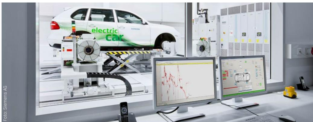
**Prüfstand für Elektroautos** in der Siemens-Geschäftseinheit „eCar Powertrain Systems“ in Erlangen.
