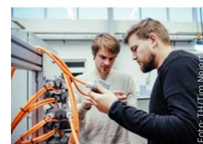
**Versuchsanlage für Batteriesysteme an der TH Nürnberg.**
