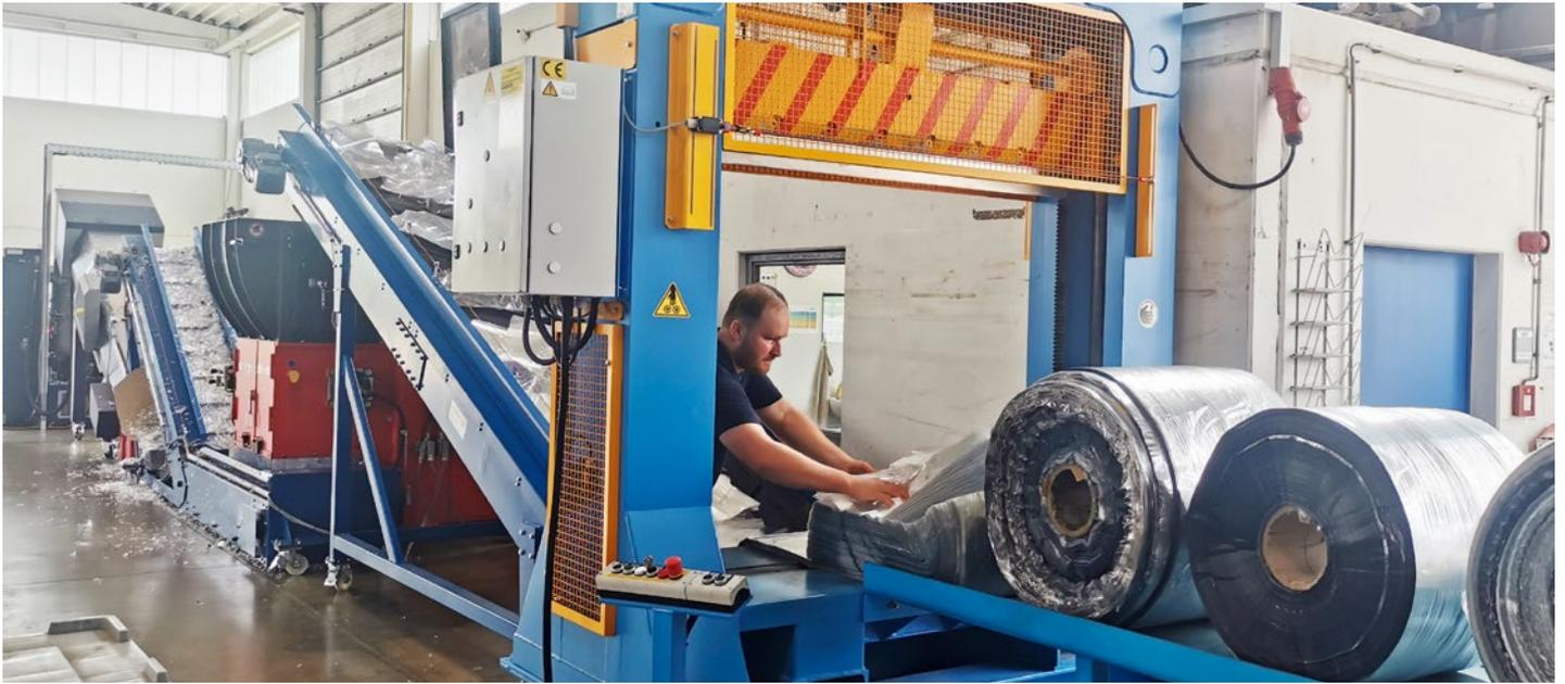
**Aus alt mach neu:** Am Extruder werden Folienreste zu wertvollen Regranulaten verarbeitet.
